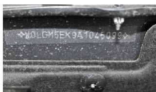
záber na VIN číslo z motorovej časti vozidla
