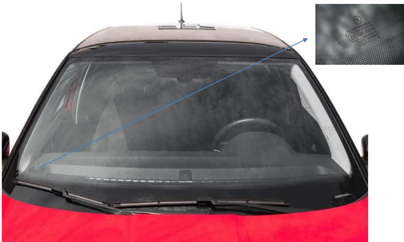
9. Fotografia čelného skla, detail výrobného čísla na skle + markanty skla.
