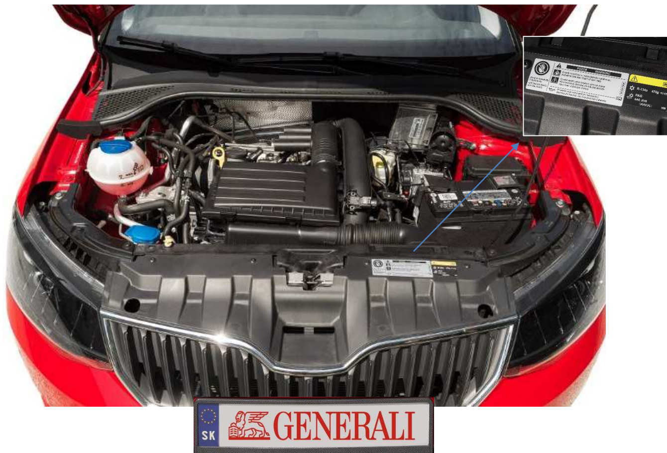
10. Motorový priestor po otvorení kapoty vozidla + štítok AC chladiva.
